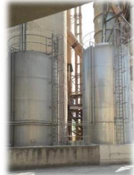
Adicionalmente existen focos puntuales de emisión de partículas a la atmósfera, correspondientes a desaireaciones de silos, descargas de cintas transportadoras, cargues, etc, que evacúan al exterior previo paso por filtro de mangas, para minimizar la emisión.
